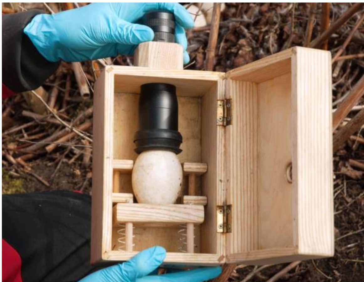
Abbildung 66: Mobile Schierstation für die Kontrolle der Eientwicklung. Im Bild das Ei einer Graugans. Zur Kontrolle wird der Deckel des Schierkastens geschlossen und das Entwicklungsstadium durch ein kleines Loch geprüft. Foto: LfL, P. Bozem, 24.03.2018.
